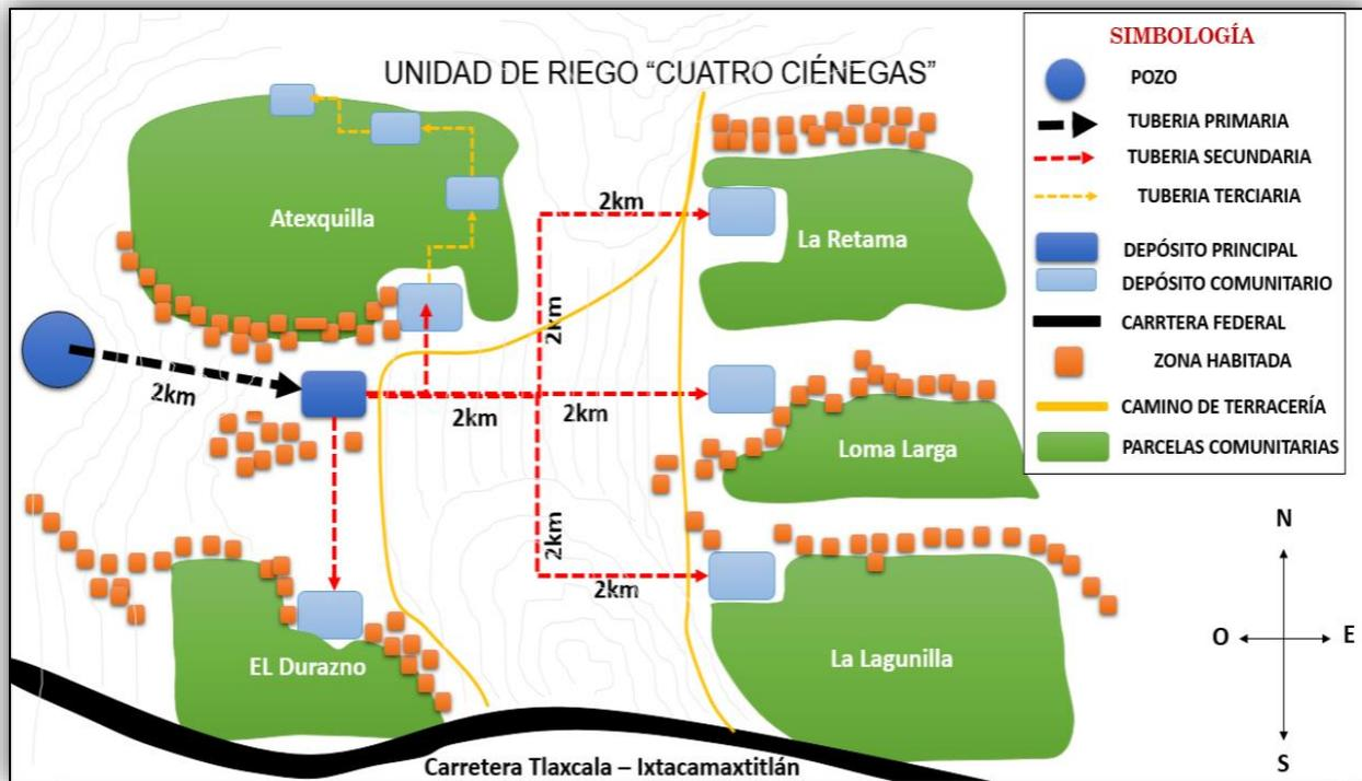
*Figura 3. Esquema de la Unidad de Pequeño Riego. Fuente: Elaboración propia con datos de trabajo de campo 2014*
